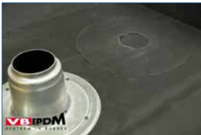
Bild 86. Durchdringungsdurchmesser zu 70% im Formteil ausschneiden.
