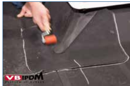
126. Anrollen des verklebten Formteils.
