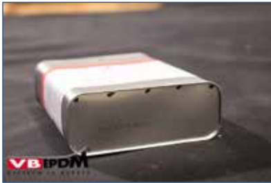
Bild 16. Öffnungen im Behälter.
